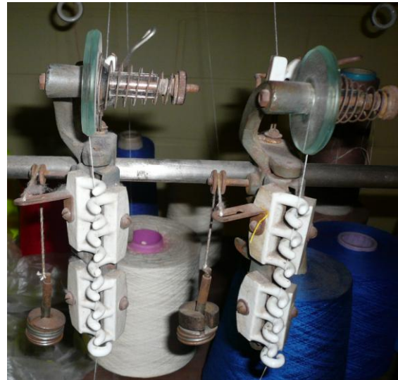
Des dents de porcelaine (terre, eau, air et feu) régulent la tension et guident les fils des ourdissoirs et autres canetières.
