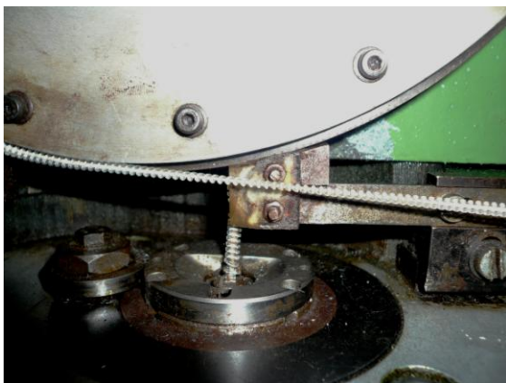
Pour réaliser une fermeture à glissière spiralée, il faut thermosouder le fil de nylon à l'âme du ruban.
