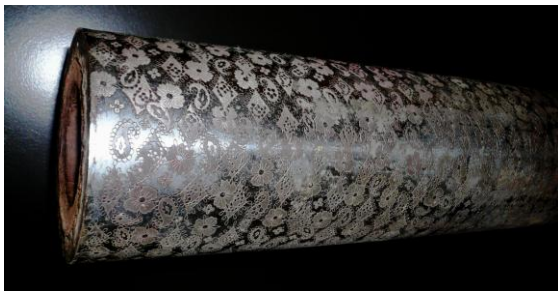
Du métal travaillé au feu, destiné à recevoir l'eau et les encres de couleurs pour teinter et imprimer le tissu (offset).
