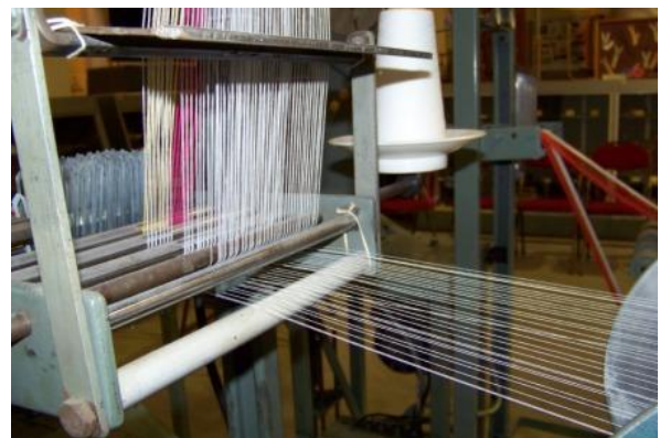
De l'ensouple au casse-chaîne... (détail du métier MRc012 tissant un ruban pour sportifs, à base de fibres de cellulose)
