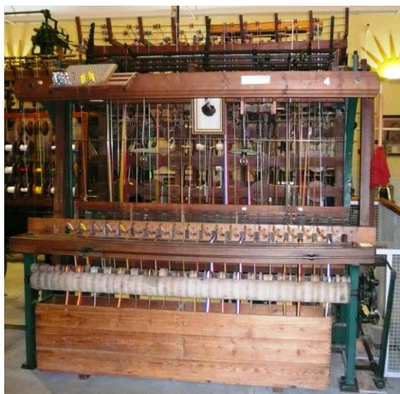
Vers 1930, Louis Masson conçoit un métier à tisser à ossature fonte (MRc004), pourvu d'un nouveau type de battant dit « à demi-lune » (ici de 1950).
