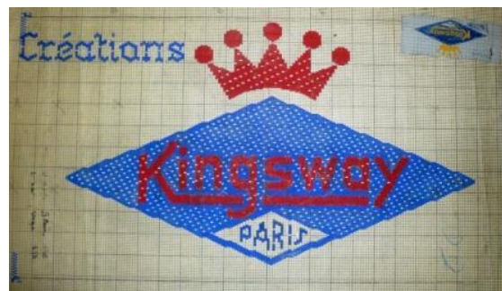
Mise en carte pour ruban jacquard à trois couleurs, réalisée d'après un modèle annexé à la pièce (MRc 1432).
