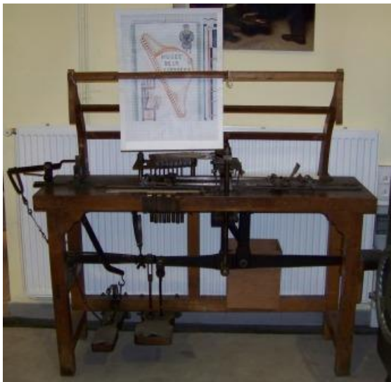
Dactyleuse ou « piano » servant à traduire la mise en carte en cartons perforés pour machine jacquard (MRC 019).
