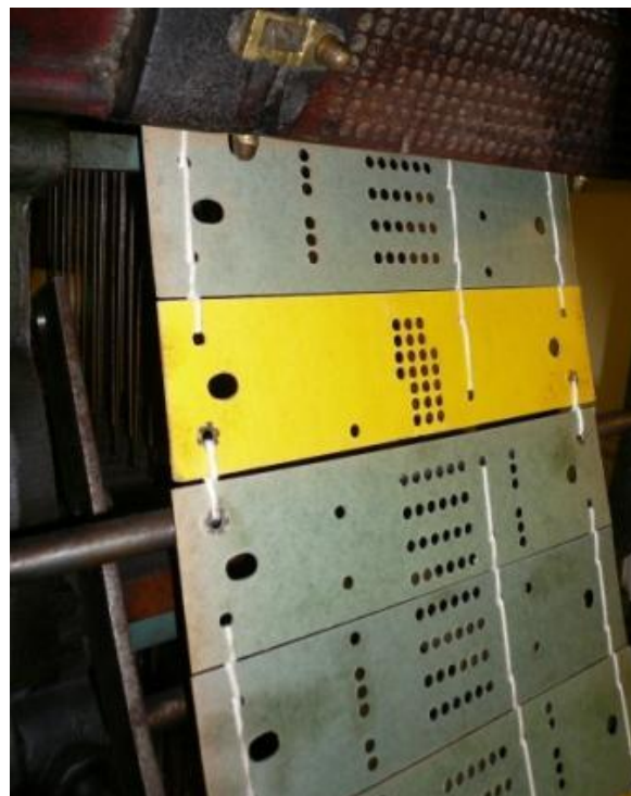
Les cartons perforés, en plus des indications liées au tissage du motif, comprennent des trous de liage et de bedonne.
